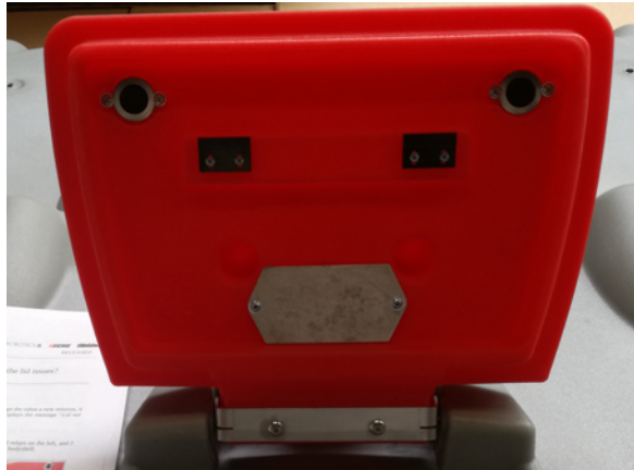
Abbildung 170: Platzierung der Magnete am Deckel
