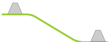
Abbildung 106: Platzierung der Ladestation bei einem abschüssigen Standort
